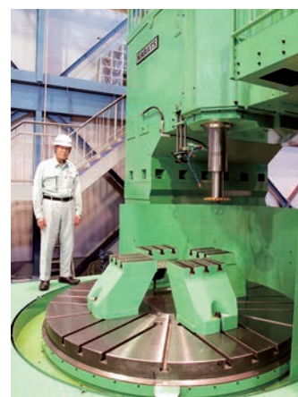
超大型歯車加工機（総重量100t） ■幅5.2m ■奥行7.5m ■高さ7.5m
